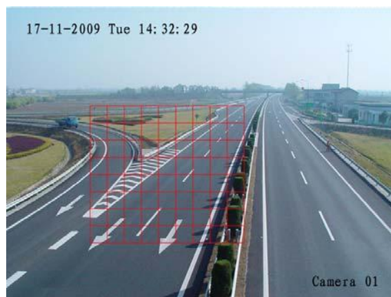
Рис. 3. Настройка зоны детектора движения
